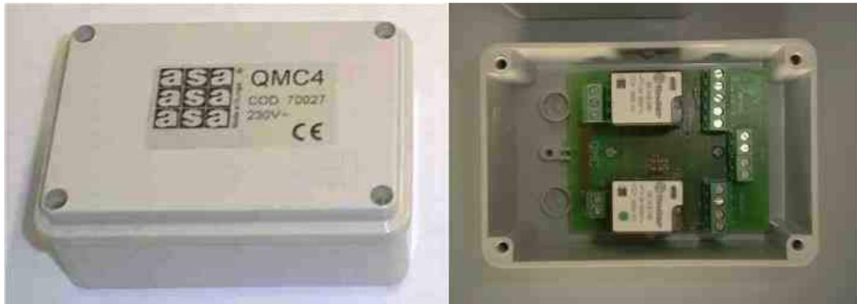
*Se i singoli motori fossero comandati da pulsanti di tipo stabile, e ordinassimo per esempio la salita di uno di loro, qualora tramite il comando generale mandassimo un contemporaneo impulso per la discesa agli altri motori, noteremmo che quello precedentemente comandato per salire rimarrebbe fermo rischiando pertanto di arrivare alla protezione termica. In questo caso occorrerebbe riportare in posizione neutra il comando del motore ed eseguire l'operazione di discesa singolarmente.*
